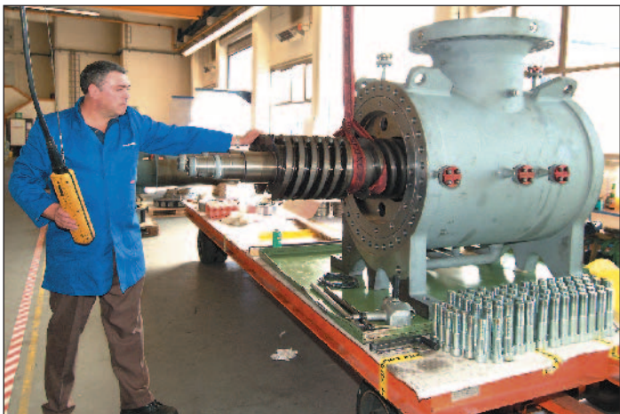
Diese Pumpen gehören zu den weltweit größten Schraubenspindelpumpen, die jemals gebaut wurden. Sie bilden das Herzstück eines Multiphasen-Pumpsystems für Exxon.
