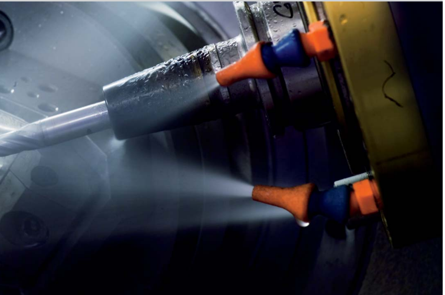
5-Achsen Fräsen eines Leitschaufelsegments
