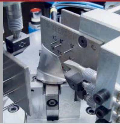
Endkontrolle einer Verdichterschaufel
