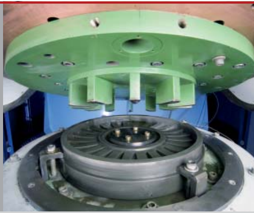
EC-Bearbeitung einer Triebwerksscheibe
