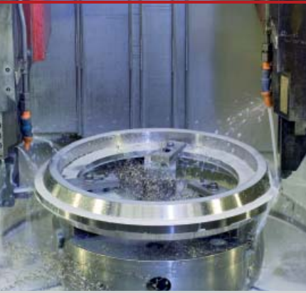
Drehen einer Triebwerksscheibe
