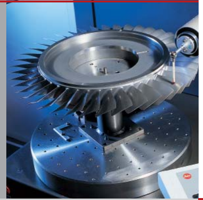
CMM-Vermessung eines Blisk/IBR
