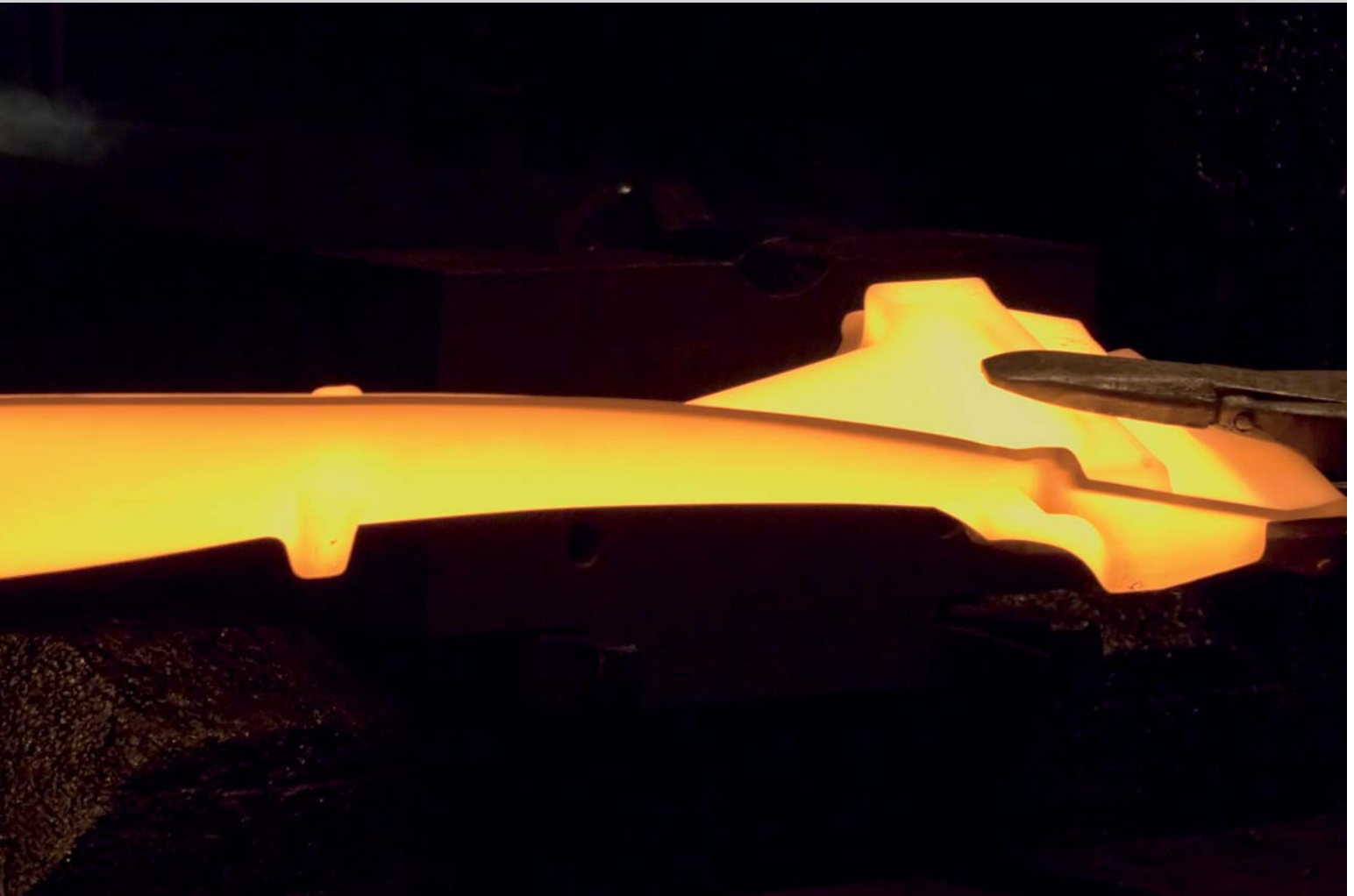
Aufmaßgeschmiedete einer ND-Dampfturbinenschaufel
