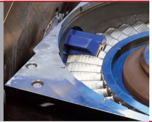
EC-Bearbeitung eines Blisk/IBR
