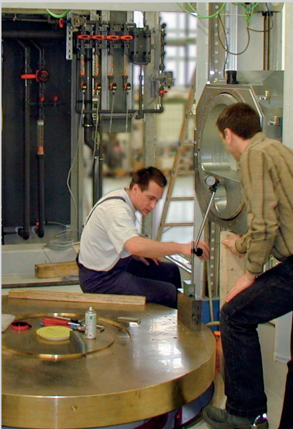
Montage einer ECM Maschine
