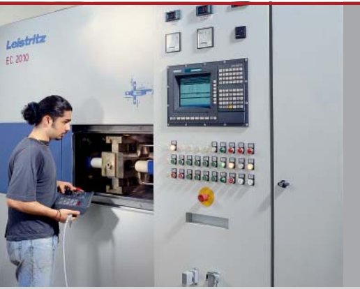
Leistriz ECM-Anlage für Verdichterschaufeln
