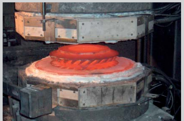
Isotherm vorgeschmiedeter Blisk aus Ti6246
