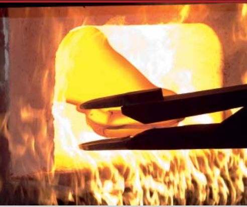
Verdichterschaufel vor dem Präzisionsschmieden
