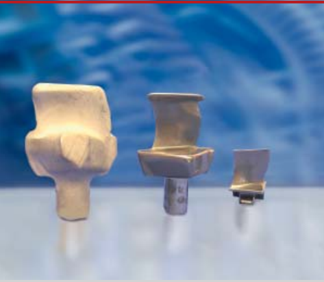
Verfahrensschritte einer TiAl Verdichterschaufel
