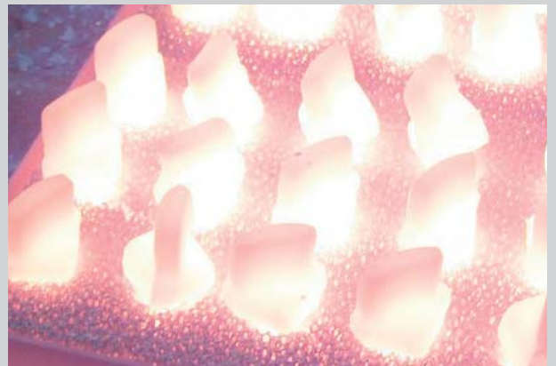
Verdichterschaufeln aus TiAl während einer Wärmebehandlung
