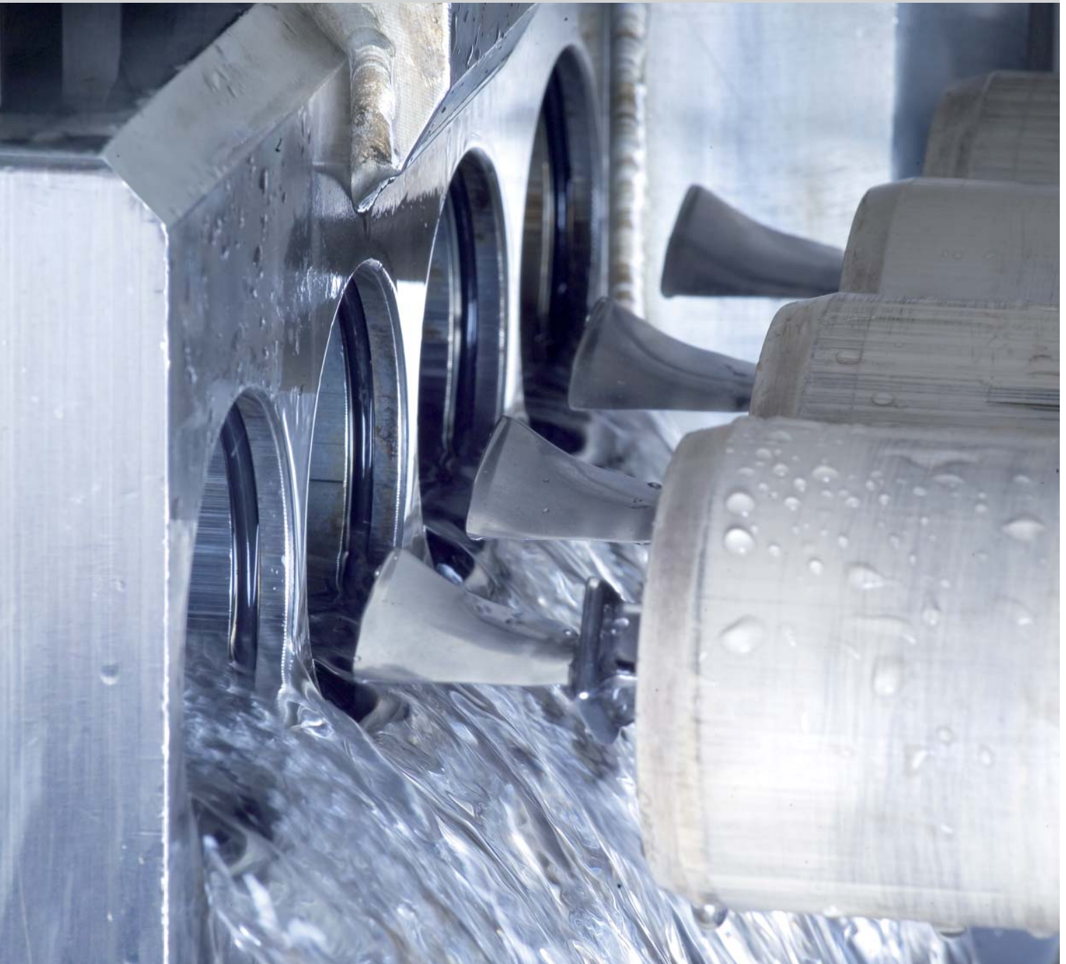
Detailansicht EC-Bearbeitung von Verdichterschaufeln
