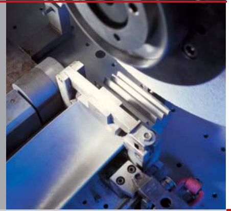
Tiefschleifen eines Tannenbaumfußes
