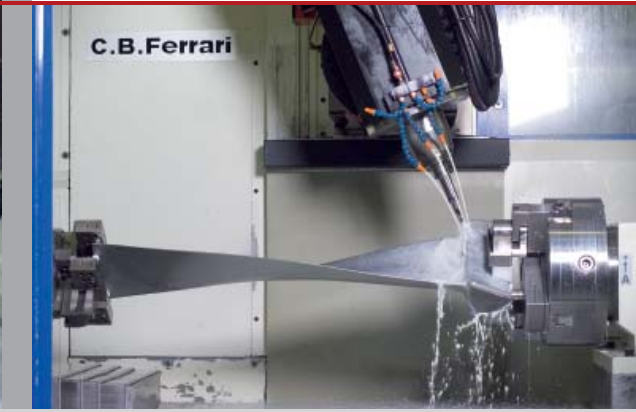
5-Achsen Fräsen einer Dampfturbinenschaufel
