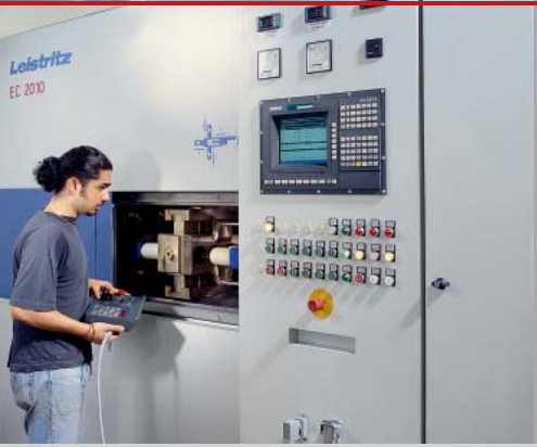
Leistriz ECM machine for compressor blades
